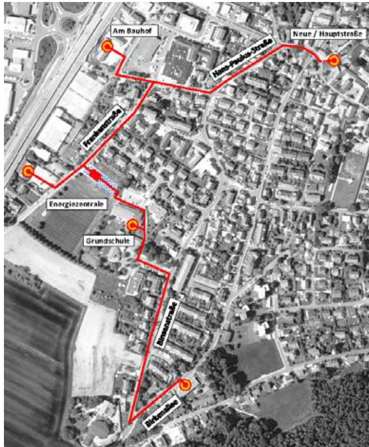
Nahwärmenetz, erster Bauabschnitt, Gemeinde 91088 Bubenreuth.
