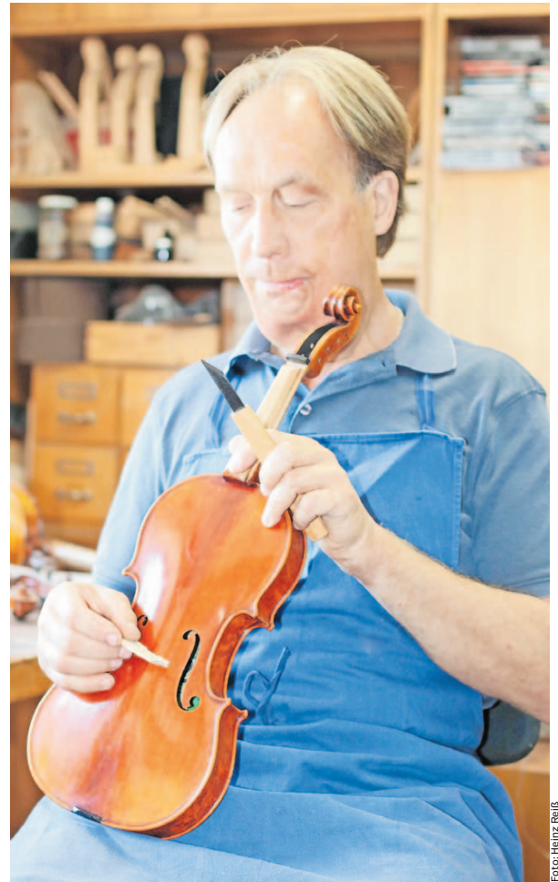
Günter Lobe beim Einpassen eines Steges. Der Geigenbaumeister aus Bubenreuth schafft etwa zehn neue Instrumente pro Jahr, manche für Kunden von weither.
