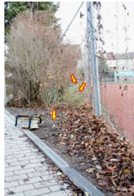
Abbildung 5: Messkette, die Pfeile deuten die Lage der Sensoren im Gelände an
