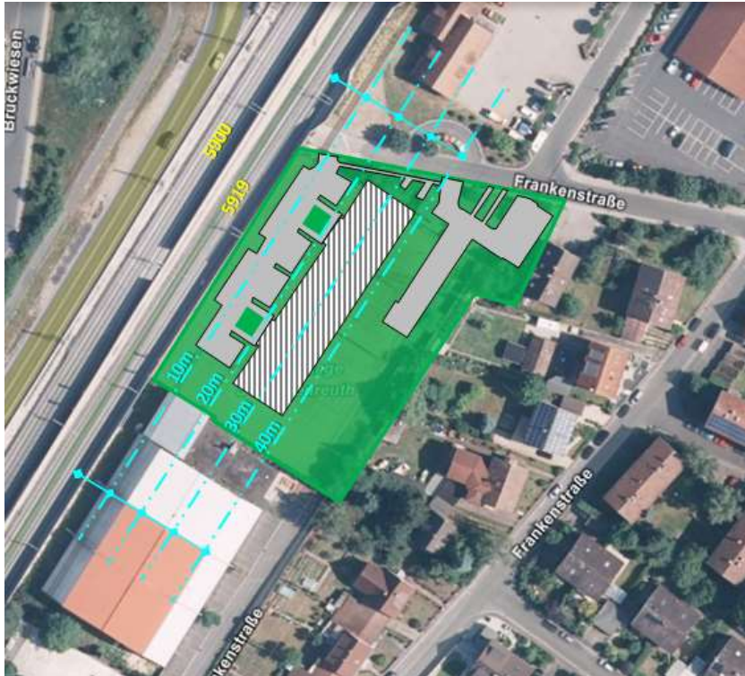
Abbildung 1: Geplante Bebauung in Bubenreuth, Frankenstrasse – schraffierte Fläche Aufstellbereich der Wohneinheiten auf der Tiefgarage; grün eingefärbt Grundstücksbereich mit Parkierungsbereich (grau eingefärbt) [9]
