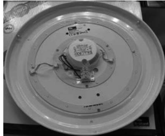
Bild 7: Deckenleuchte mit nichttauschbaren LEDs
